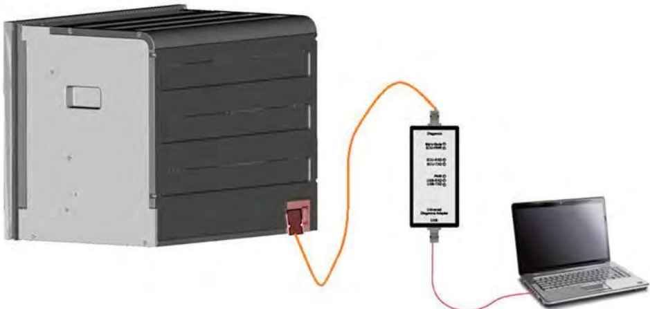
شکل: UDA box بوسیله کابل D-Bus 2 به کارت SDS نصب شده به پشت دستگاه
